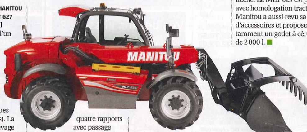
quatre rapports avec passage sous couple (vitesse maximum 32 km/h). Le circuit hydraulique est alimenté par une pompe à engrenages de 85 l/min. La cabine a été entièrement revue pour améliorer son confort avec un tableau de bord à écran digital offrant
